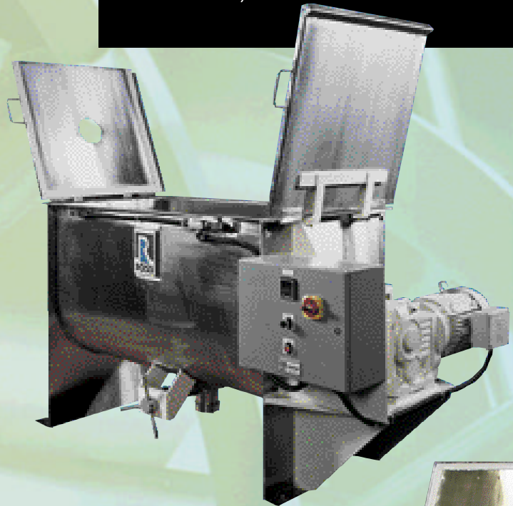
Licuadora de Cinta Modelo 42N-1, de 1 cu. ft., 3/4HP, acero inoxidable.
